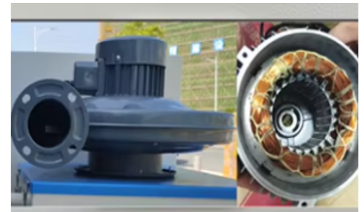
Pulsed dust removal fan
